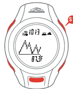
ANZEIGE 3 Obere Linie: LUFTDRUCK MSL Mittellinie: GRAPH LUFTDRUCK DER LETZTEN 24 STUNDEN Untere Linie: TEMPERATUR
