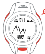
ANZEIGE 2 Obere Linie: LUFTDRUCK MSL Mittellinie: GRAPH LUFTDRUCK DER LETZTEN 24 STUNDEN Untere Linie: LOKALER UNANGEPASSTER LUFTDRUCK
